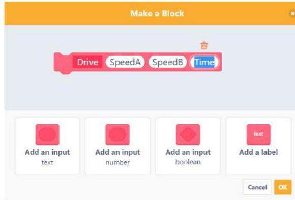
A ideia básica é obter os valores SpeedA e SpeedB (intervalo aceitável: -255 a 255), verificar se algum deles é negativo (ou ambos) e, se for, inverter a direção definindo o pino de direção correspondente. Mas para acionar o motor tem de usar o valor absoluto no pino PWM.
