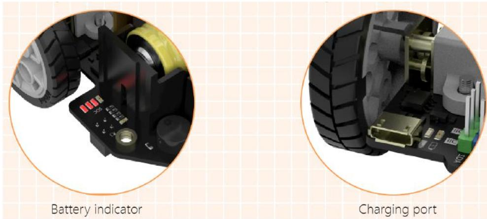
Quando a bateria está totalmente carregada, todos os LEDs acendem. Os LEDs apagarão um por um à medida que a capacidade da bateria diminui gradualmente. Se todas as luzes se apagarem, a bateria precisa ser carregada. Use um carregador de smartphone e conecte-o à porta de carregamento. Observe que a porta de carregamento serve apenas para carregar. Para programar o robô Maqueen Plus - use o micro conector USB no micro:bit.
