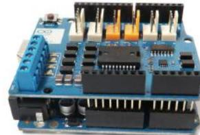
O shield do motor tem 2 canais, o que permite o controlo de dois motores DC ou 1 motor de passo.
