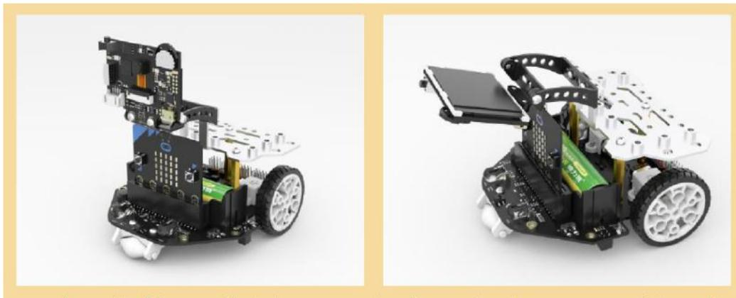
4) Monte a câmera HuskyLens 5) Coloque a placa micro:bit no slot
